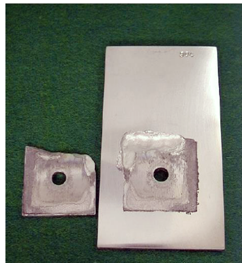
図 19. 3 年間自然海水に浸漬したすき間構造を有するステンレス鋼 SUS304 試験片
