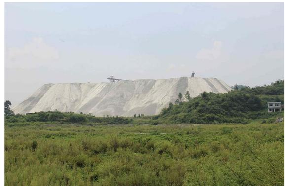
図4. リン鉱石からリン酸を製造する過程で出るリン酸石膏の廃棄物でできた山(中国貴州省開磷市)。
