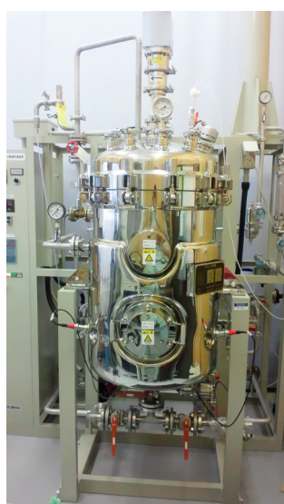
図5. 200 L 容量の発酵槽
