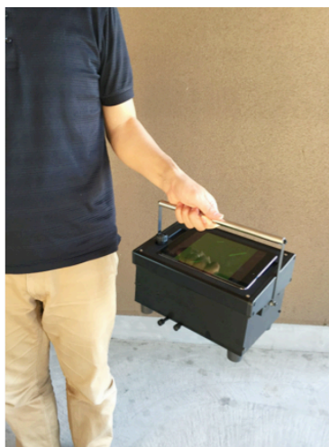
図 4. 携帯型蛍光顕微鏡。Z 軸の調整は iPad 横のつまみで調整する。X、Y 軸の調整はボックス下のつまみで調整する。画面上の倍率は約 300 倍で、iPad の画面の拡大により約 1,000 倍まで拡大できる。携帯型蛍光顕微鏡を利用している様子は、シリコンバイオ社のホームページで公開されている（ http://www.siliconbio.co.jp ）。
