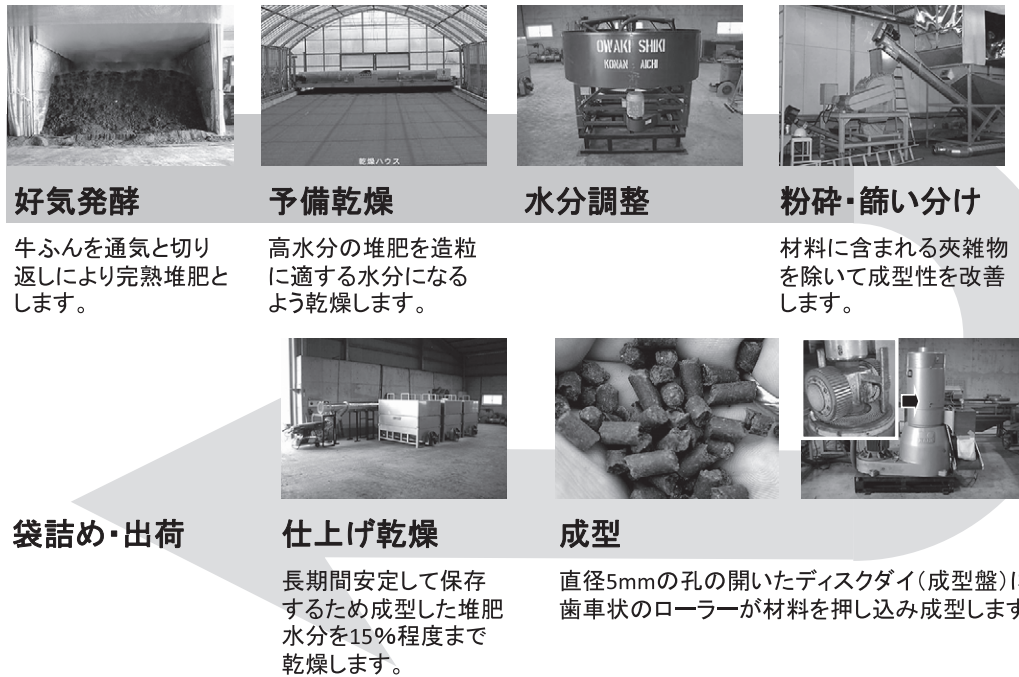
図1. 牛ふん堆肥ペレットの製造工程 (ローラー・ディスクダイ方式による造粒)
