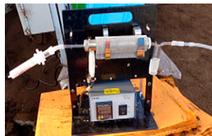
2) 加熱脱着ガスを検知管で評価
