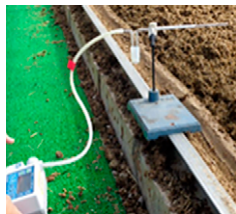
1) 試料ガスを捕集管に濃縮
