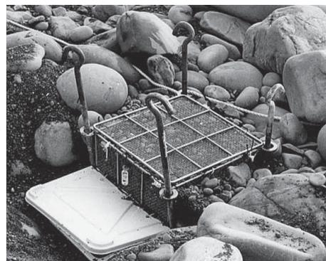
図4. 種子島東岸部とサロマ湖岸東岸部における試験現場に埋設したステンレス網籠
