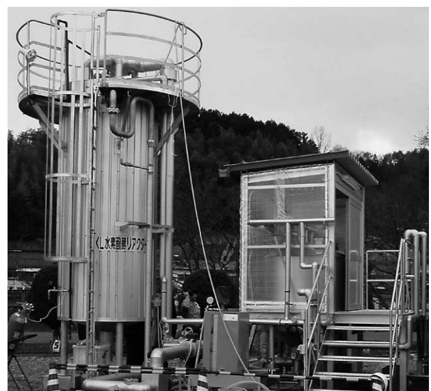
図5. 水素発酵パイロットプラント (5 m 3 )
