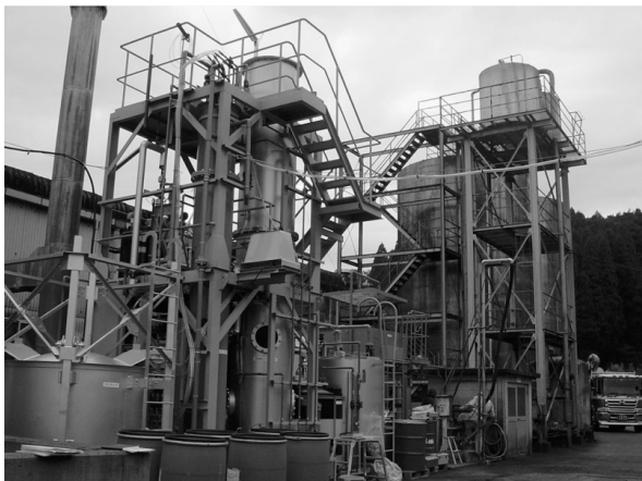
図4. 世界最高速度のメタン発酵バイオリクターのパイロットプラント。経産省「地域コンソーシアム研究開発事業」として、鹿児島県の焼酎メーカーに設置され、実証試験中。
