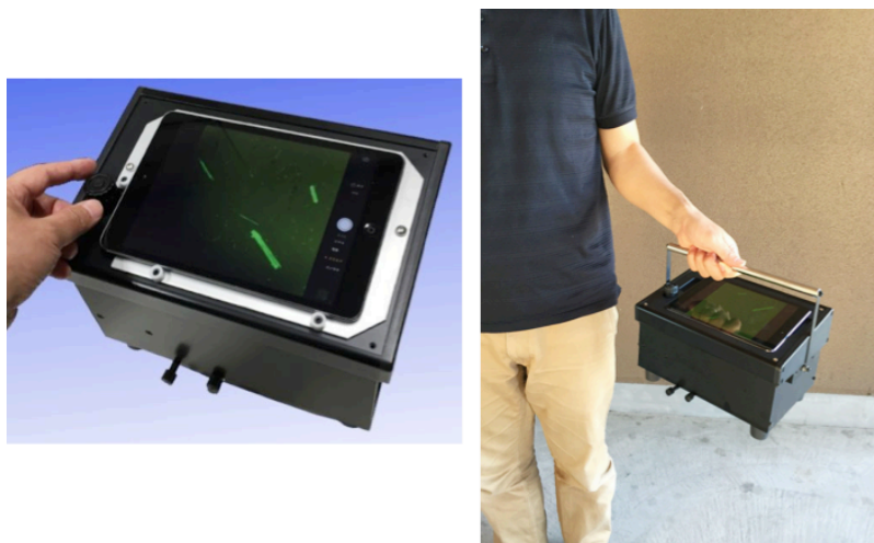
図4. 携帯型蛍光顕微鏡。Z軸の調整はiPad横のつまみで調整する。X、Y軸の調整はボックス下のつまみで調整する。画面上の倍率は約300倍で、iPadの画面の拡大により約1,000倍まで拡大できる。携帯型蛍光顕微鏡を利用している様子は、シリコンバイオ社のホームページで公開されている ( http://www.siliconbio.co.jp )。
